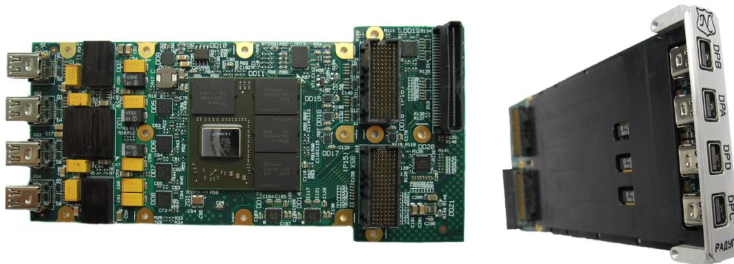
Видеокарта «Радуга» выполнена в конструктивном исполнении VITA 42 XMC и способна поддерживать до шести дисплеев, с комбинацией из интерфейсов: **DisplayPort 1.2, DVI, HDMI, SVGA**, а также **LVDS** для подключения ЖК панели. Видеокарта «Радуга» может поддерживать:
