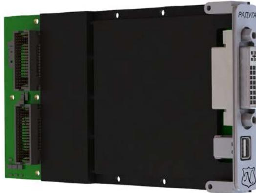
Видеокарта «Радуга» выполнена в конструктивном исполнении VITA 42 XMC и способна поддерживать до трёх дисплеев одновременно, с комбинацией из интерфейсов: **DisplayPort 1.2, DVI и VGA**:
