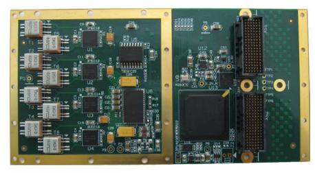
«XMC-1553UD4» — модуль четырёх резервированных мультиплексных каналов информационного обмена (МКИО) в конструктивном исполнении XMC - VITA42 (ANSI/VITA 20-2001)
