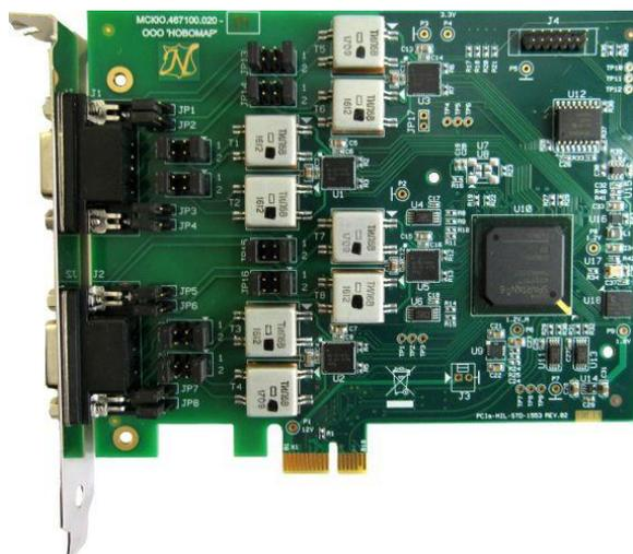
«PCIe-1553UD4» – модуль четырех резервированных мультиплексных каналов информационного обмена (МКИО) в конструктивном исполнении PCI Express Standard height, half length card x1.
