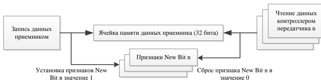
Рисунок 11. Формирование признака “New Bit” для режима работы в режиме коммутатора с памятью приемника.
