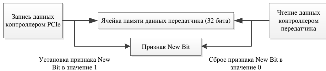
Рисунок 8. Формирование признака “New Bit” для режима работы с внутренней памятью.
