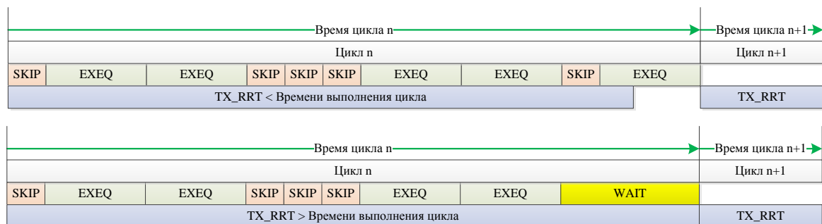
Рисунок 7. Связь работы таймера RRT с различными ситуациями времени выполнения циклов.
