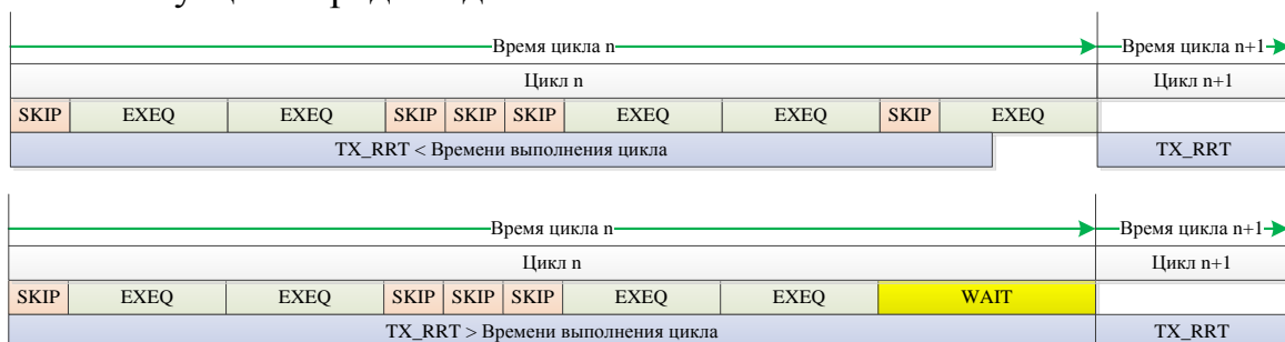
Рисунок 11. Связь работы таймера RRT с различными ситуациями времени выполнения циклов.
