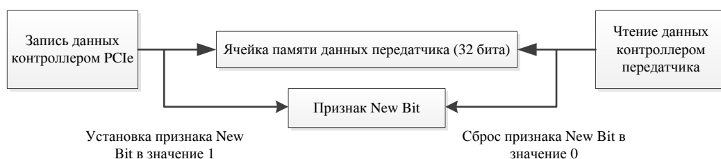
Рисунок 9. Формирование признака “New Bit” для режима работы с внутренней памятью.
