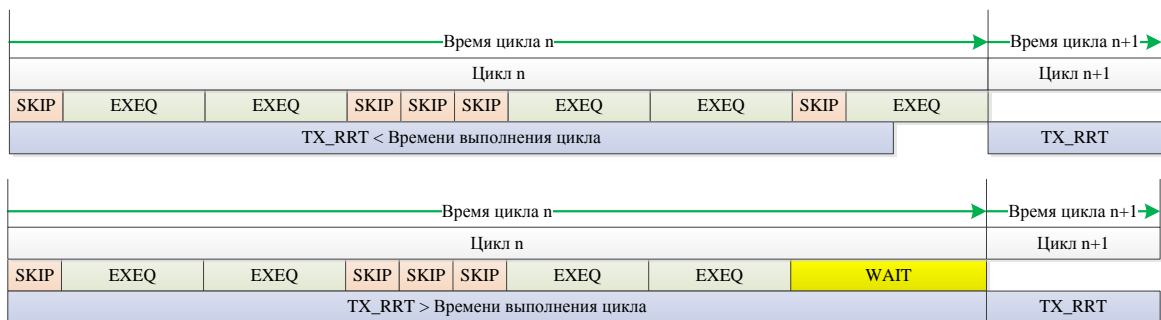
Рисунок 8. Связь работы таймера RRT с различными ситуациями времени выполнения циклов.
