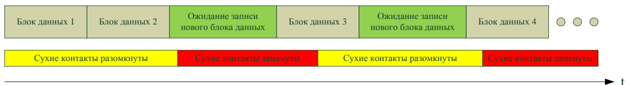
Рисунок А.2. Временная диаграмма теста 2 при отключенном таймере RRT.
