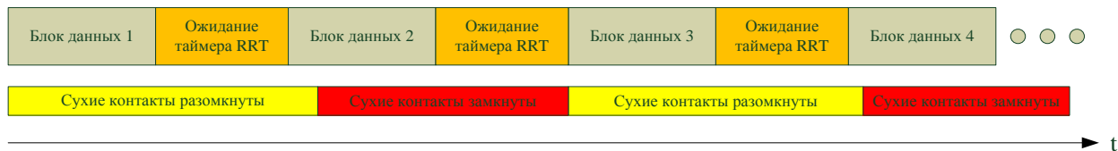
Рисунок А.3. Временная диаграмма теста 2 при включенном таймере RRT.
