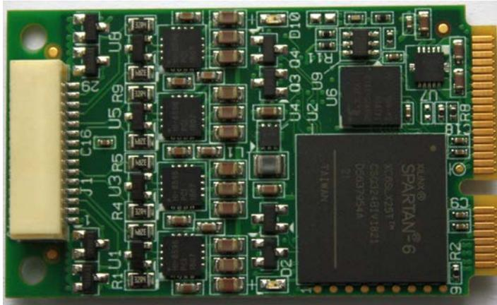
“mPCIe-429UD84” – модуль подключения ПК к интерфейсу ARINC 429 (последовательный код- ПК по ГОСТ 18977-79 и РТМ1495-75) и дискретным каналам (Разовые Команды - РК) по ГОСТ 18977-79. Модуль выполнен в конструктивном исполнении **mini PCI Express**.
