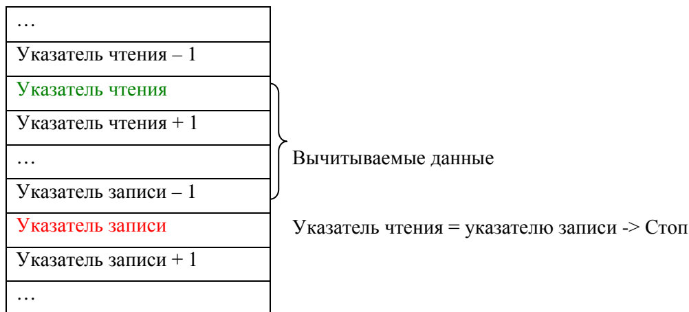
Рисунок 2. Указатели в буфере DMA.
